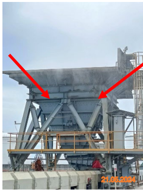
ภาพที่ 2-3 การฉีดพรมน้ำในระหว่างขนถ่าย ถ่านหินจากเรือลงบนฮอปเปอร์รับถ่านหิน
